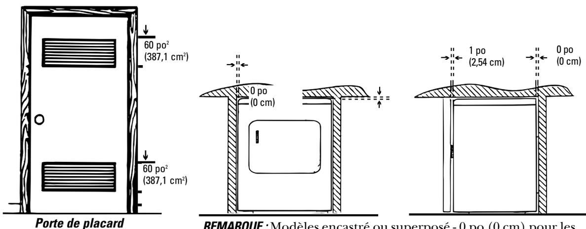
**REMARQUE :** Modèles encastré ou superposé - 0 po (0 cm) pour les côtés, l'arrière et le dessus.
