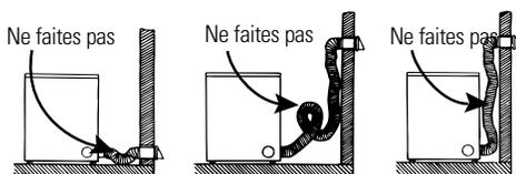
**⚠ MISE EN GARDE :** Voici des exigences spécifiques pour l'utilisation convenable et sécuritaire de votre sècheuse. Le défaut de suivre ces directives peut causer un allongement des temps de séchage et présenter des dangers d'incendie.
