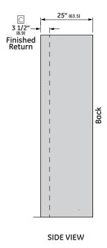
DUAL INSTALLATION 18" INTEGRATED FREEZER, ZIF180NPKII AND 30" INTEGRATED REFRIGERATOR, ZIR300NPKII
