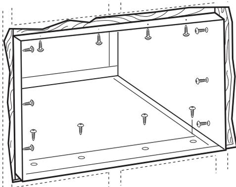
**C** Coloque la carcasa en la abertura de la pared y coloque guías de soporte de madera entre la parte inferior de la carcasa y el revestimiento de aislación sobre ambos lados del riel inferior. Deben ser de la misma altura del riel inferior y de la misma longitud de la abertura de la pared.
