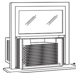
C Reinstale el control en el espacio del panel reemplazando los 2 tornillos que retiró previamente.
