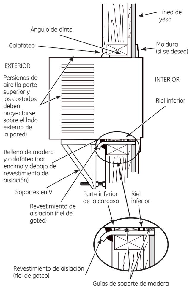
**B** Coloque el acondicionador de aire dentro de la carcasa. Para instrucciones específicas, consulte las Instrucciones de instalación en una ventana.
