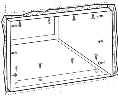
**C** Positionnez le logement dans l'ouverture dans le mur et placez les bandes de maintien en bois entre le bas du logement et le solin des deux côtés du rail inférieur. Elles doivent être de la même hauteur que le rail inférieur et de la même longueur que l'ouverture dans le mur.
