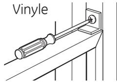
Fixez la ferrure de verrouillage de la fenêtre à l'aide d'un vis de type C.
