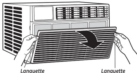
**⚠ MISE EN GARDE:** NE faites PAS fonctionner le climatiseur sans le filtre sous peine de le boucher avec de la poussière et de la charpie et de réduire son efficacité
