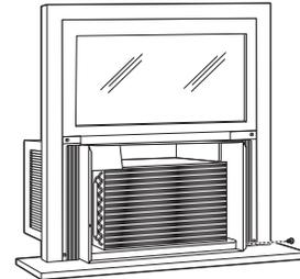
C Montez de nouveau la commande sur le boîtier du panneau en remettant en place les 2 vis ôtées plus tôt.
