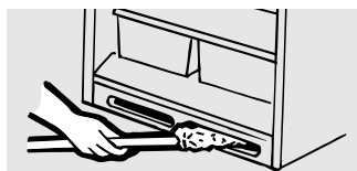
Limpe las bobinas del condensador al menos una vez al año.
