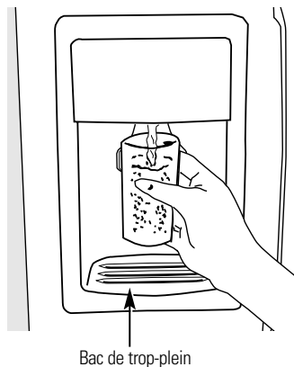
Bac de trop-plein
