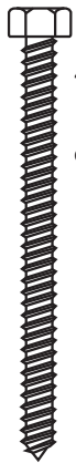
4 vis à bois à tête hexagonale (6 mm x 2-1/2 po ou 1/4 x 2-1/2 po)
