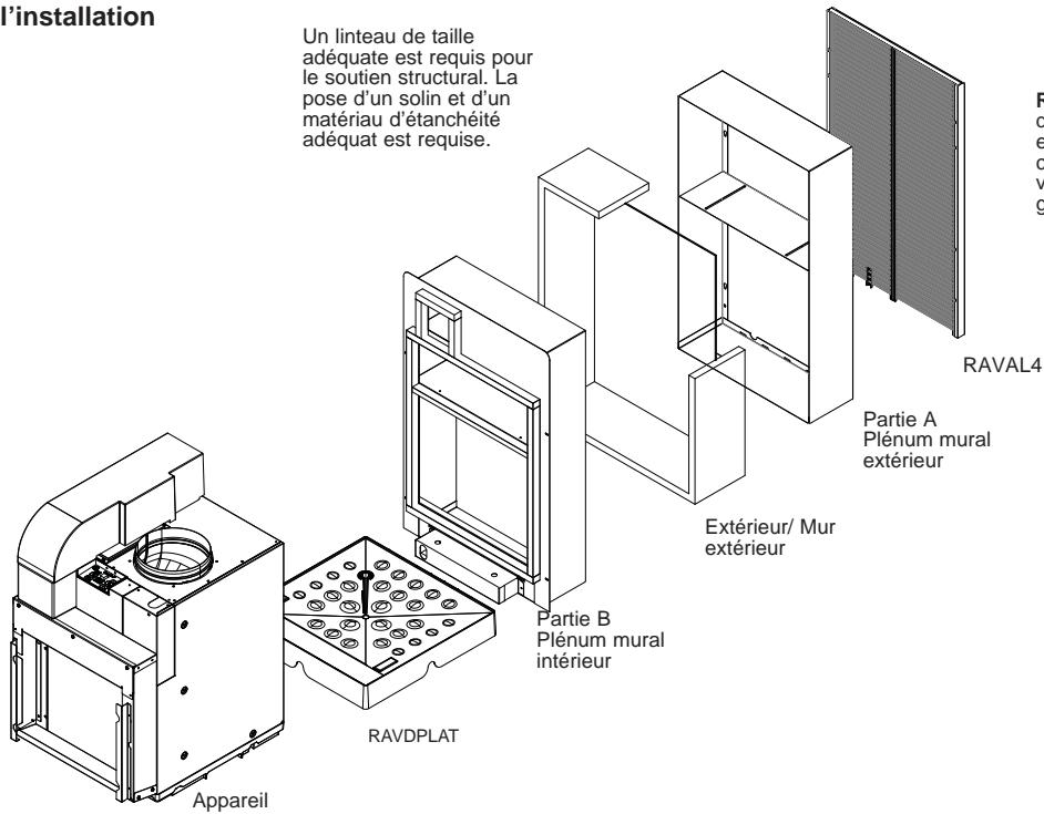
**REMARQUE:** le plenum dispose d'un capot protecteur en carton ciré. Ne retirez pas ce couvercle jusqu'à ce que vous soyez prêt à installer la grille (Ens. n° RAVAL4).
