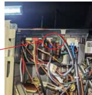
**Paso 3:** El SW2-4 se deberá ajustar en OFF (Apagado)
