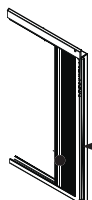
Recorte y aplique la tira de protección climática al lateral del marco de la cortina (una a cada lado).
