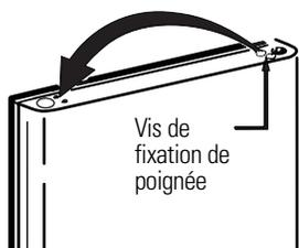
Retirez le capuchon placé à gauche du rebord du haut de la porte et mettez-le dans le trou du côté opposé.
