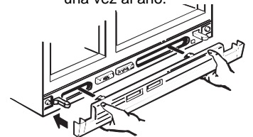
Limpie las bobinas del frigorífico al menos una vez al año.
