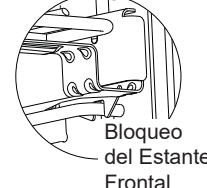
Sostenga el riel frontal superior y las manijas inferiores y empuje el estante hasta que la función de instalación se bloquee en el soporte frontal.
