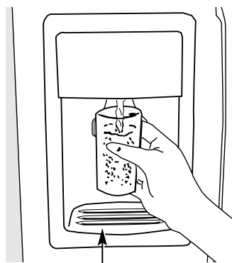
Bac de trop-plein
