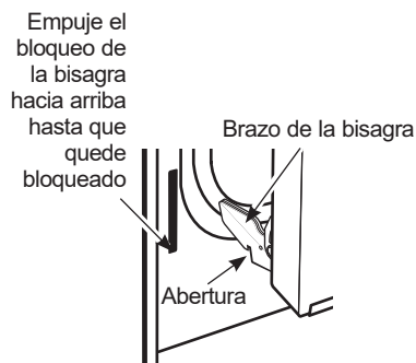
Apoye la abertura en el extremo inferior de la ranura de la bisagra
