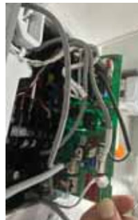
4. Retire la placa del circuito impreso (PCB) y desenchufe el sensor de pérdida de refrigerante del CN3.
