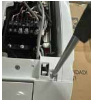
2. Retire el panel del marco derecho.
