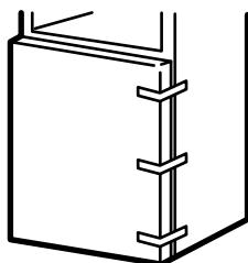
3.2 Con un destornillador de casquillo de cabeza hexagonal de 5/16" y una llave abierta de 5/16", retire los dos tornillos que sostienen la bisagra del centro (y la lámina pegada a ésta) con el gabinete. Levante la bisagra del centro para liberar su pasador del casquillo en la parte superior de la puerta, y ponga la bisagra y los tornillos a un lado. **Tenga cuidado de no aflojar el separador y la arandela de la bisagra del centro.**
