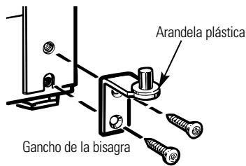
4.3 Intercambie la bisagra (y la lámina pegada a ésta) y los tornillos en la parte superior derecha con tornillos en la parte superior izquierda del gabinete. **No apriete los tornillos en el lado de las bisagras en este momento.**
