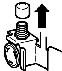
9.3 Coloque la tuerca de compresión y la férula (manga) en el extremo de la tubería como se muestra.
