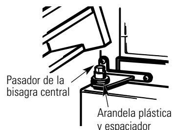
**6.2.2** Incline la puerta hacia el gabinete, levantando la bisagra superior de manera que el pasador encaje en el casquillo en la parte superior de la puerta.
