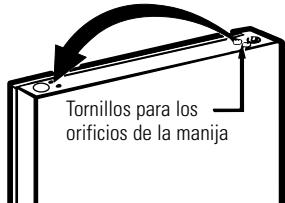
5.1.4 Con una espátula con cinta o un destornillador delgado, apalanque el botón del tapón desde el orificio de la bisagra en el lado izquierdo de la puerta e insértelo en el orificio en el lado opuesto que se desocupó al retirar la bisagra superior.
