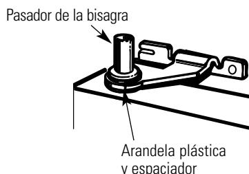
**6.1.3** Incline la puerta hacia el gabinete. A medida que la puerta vuelve a su posición, deslice la bisagra debajo de la cabeza del tornillo que anteriormente se había insertado parcialmente en el orificio más externo. Inserte el tornillo restante, luego apriete ambos tornillos firmemente.
