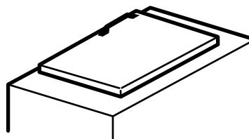
3.5 Con un destornillador Torx, traslade los dos tornillos del lado opuesto del gabinete hacia los orificios de los tornillos desocupados al retirar la bisagra del centro.
