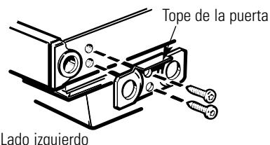
5.2.2 Mueva cualquier tornillo del extremo izquierdo hacia el extremo derecho.
