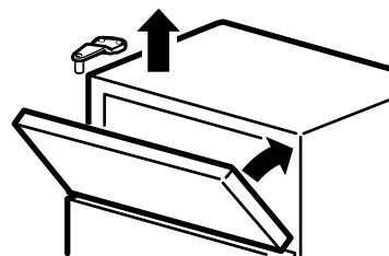
**6.2.3** Asegúrese de que la puerta esté ligeramente por encima del gabinete y que el espacio entre las puertas sea uniforme a lo ancho del frente. Apriete los tornillos de la bisagra superior. No apriete demasiado estos tornillos, apriételos hasta que estén ajustados, luego gírelos otro medio giro.
