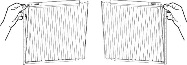
**D.** Deslice el extremo libre del panel con forma de acordeón sobre los rieles del panel lateral. Deslice el panel hacia abajo. Asegúrese de dejar espacio suficiente para deslizar la parte superior e inferior de la estructura sobre los rieles en el gabinete.
