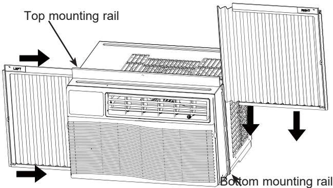
**E.** Deslice los paneles con forma de acordeón derecho e izquierdo sobre los rieles de montaje superior e inferior.
