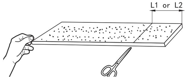
**C.** Retire el adhesivo de la parte trasera del aislante de gomaespuma. Adhiera el aislante de gomaespuma en el acordeón derecho e izquierdo, y dentro de los marcos.
