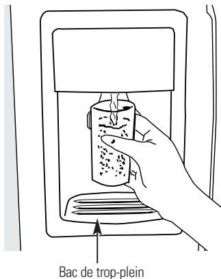
Bac de trop-plein
