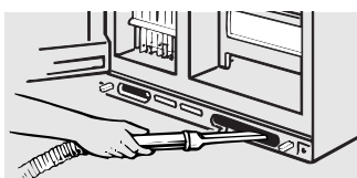
Nettoyez les bobines du condenseur au moins une fois par an.
