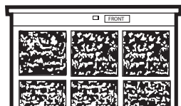
Filtro atascado – Gran reducción de la refrigeración, calefacción y flujo de aire.
