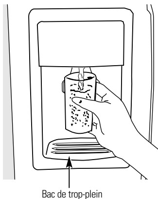
Bac de trop-plein
