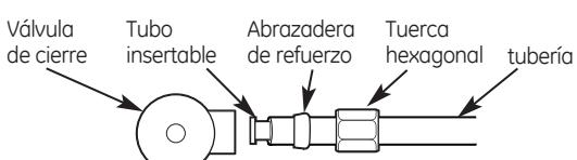
**NOTA:** Un ajuste excesivo hará que la tubería se separe de la unión.
