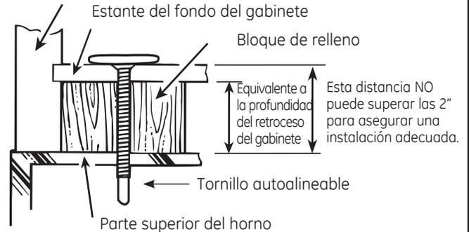
**4** Inserte 2 tornillos (1/4"-28 x 2 5/8") autoalineables a través de los agujeros exteriores superiores del gabinete. Gire dos vueltas completas en cada tornillo.
