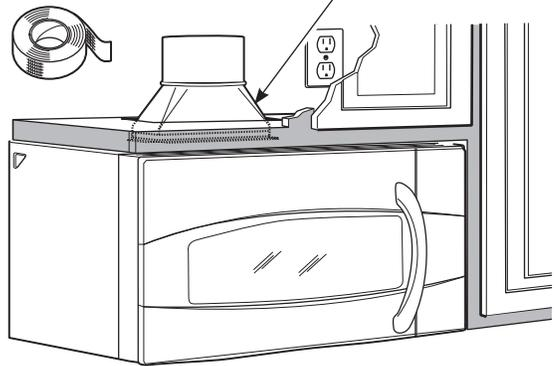
1 Extienda el conducto de la casa hacia abajo para conectarlo con el adaptador de escape.
