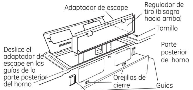
Empuje firmemente hasta que esté en las orejillas de cierre inferiores. Tenga cuidado de asegurarse de que la bisagra del regulador de tiro esté instalada de forma que esté en la parte superior y que el regulador de tiro gire libremente.
