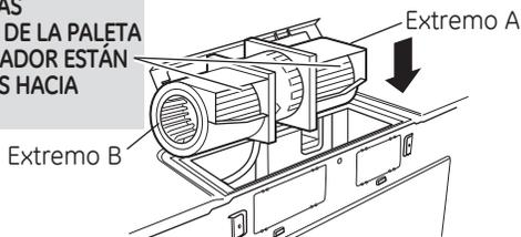
**⚠ ADVERTENCIA:** Existe riesgo de descargas eléctricas que pueden ocasionar lesiones o la muerte. No empuje ni extienda el cableado de la unidad de ventilación. Asegúrese de que los cables no posean cortes.
